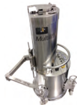
Подъем осуществляется телескопической мачтой в закрытой средней мачте с помощью 2 ходовых винтов с сервоприводом; в качестве подъемного элемента используется плоский ремень с семикратным запасом прочности на разрыв
