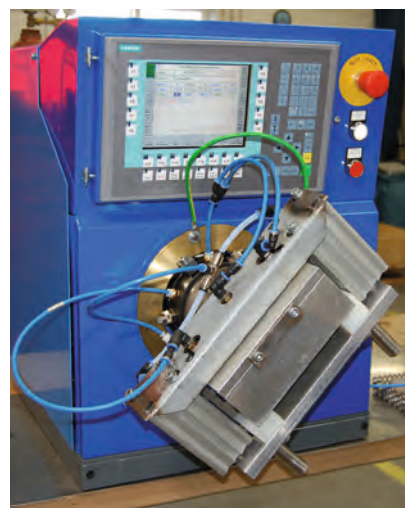
Илл. 8: Орбитальная сварка вольфрамовым электродом в среде инертного газа (WIG) способствует оптимальной конструкции компонентов гигиенических трубопроводов
