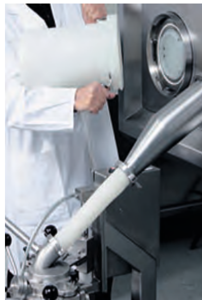
Илл. 4: Стыковочный порт быстрой передачи (RTP) обеспечивает многократные передачи, например, при замене инструментов для таблетирования
