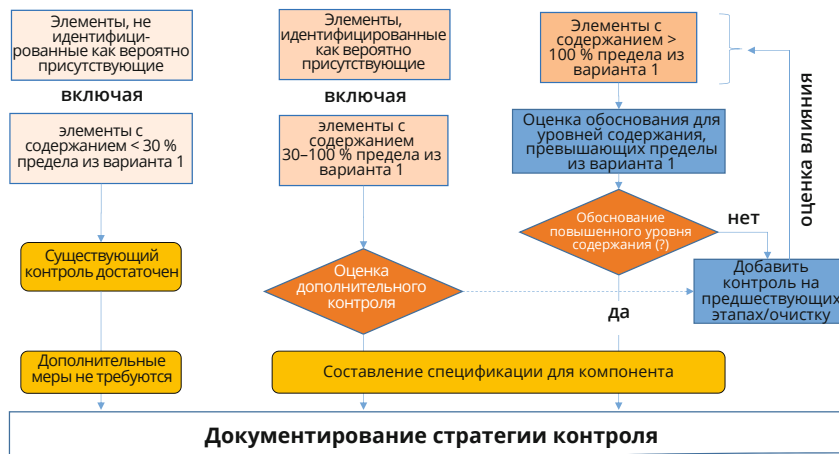
Илл. 5: Стратегия контроля для компонентов на основании предельных значений концентрации из варианта 1, принятых по умолчанию
