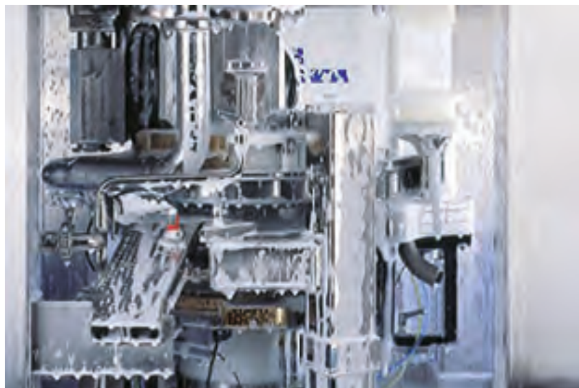
Илл. 5: В установке, заключенной в защитную оболочку, все детали, контактирующие с продуктом, должны очищаться с использованием автоматизированной программы мойки
