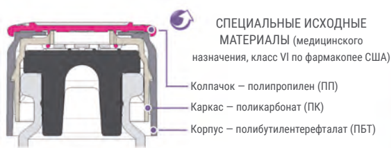
Илл. 1a и 1b: Система укупоривания предварительной сборки; пластиковый колпачок с интегрированной пробкой (источник: ARaymondlife)
