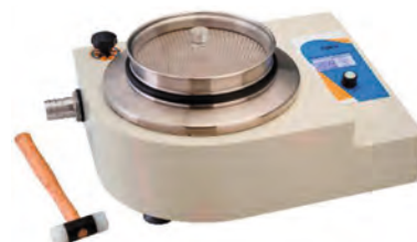
С помощью вращающейся лопасти с соплом, которой оснащена лабораторная просеивающая машина KLS, материал перемешивается воздухом; одновременно снизу продувается ситовая ткань
